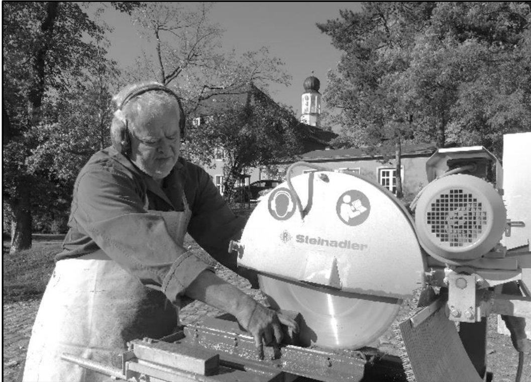
Abb. 5: Mit einer Diamantsäge werden Bohrkern am IGW der Universität Jena längs zersägt.
