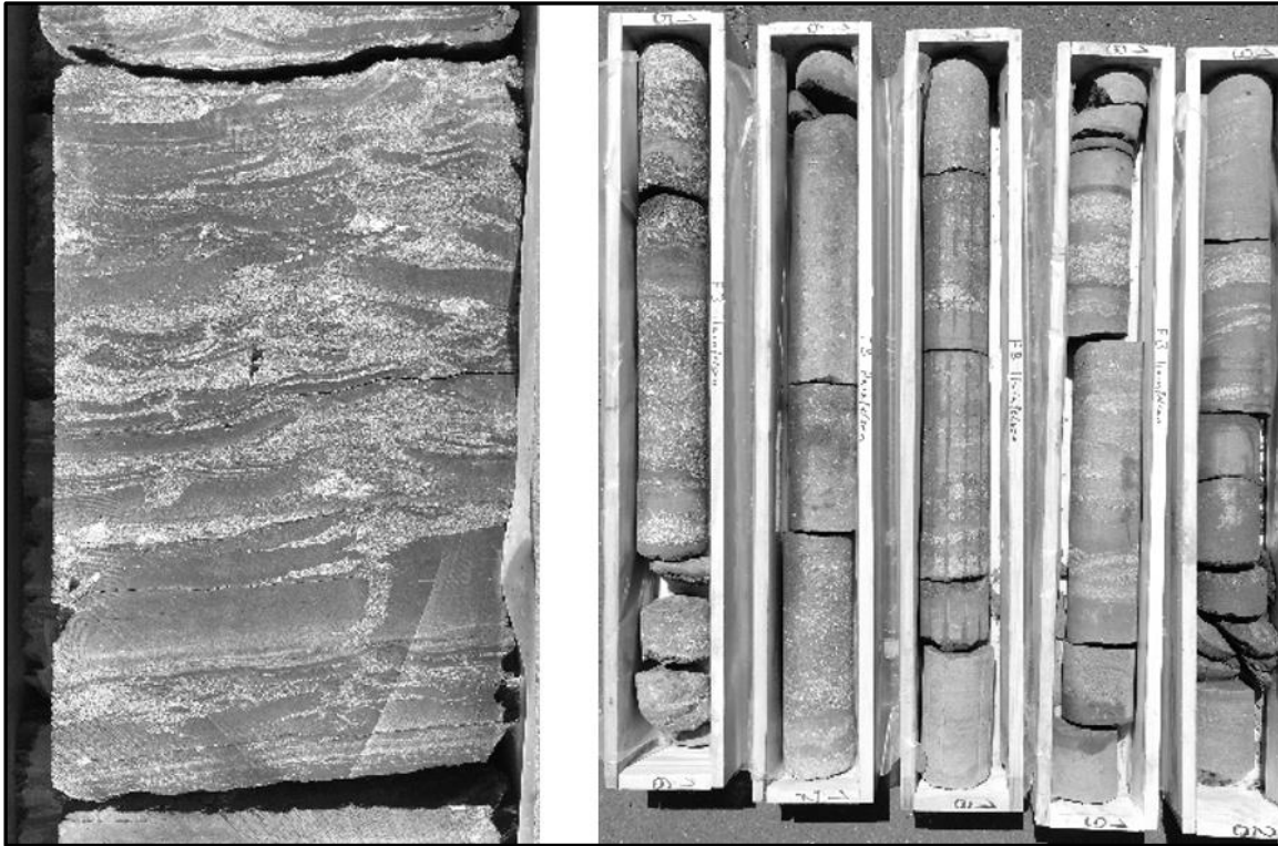
Abb. 3: Beispiele von Bohrkernen und deren Einpassung in Kernkisten. Links: Ein später längs zersägter Bohrkern.
